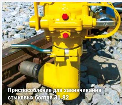
Приспособление для завинчивания стыковых болтов 31.82
