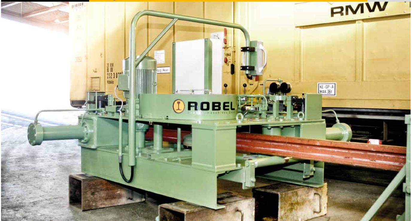
Máquina curvadora/enderizadora de 4 rodillos con ajuste hidráulico del rodillo para curvar o enderezar rieles Vignol y de garganta.
