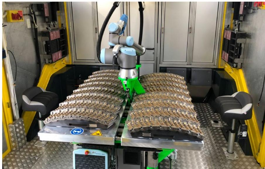
3: Roboter unterstützte Indexierung der Wendeschneidplatten in der maschinenintegrierten Werkstatt
