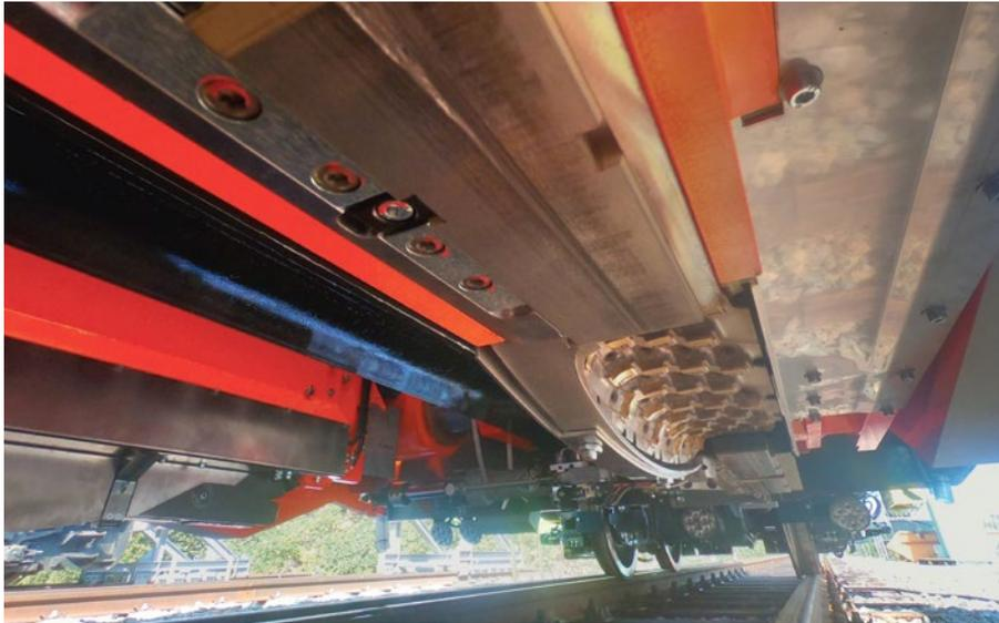
2: Fräseinheit auf dem Schienenbearbeitungssystem Romill Mainline – Ansicht von unten
