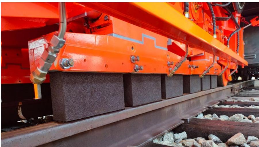
4: Finishing-Einheit mit oszillierender Rutschersteintechnologie zur funkenfreien Nachbearbeitung
