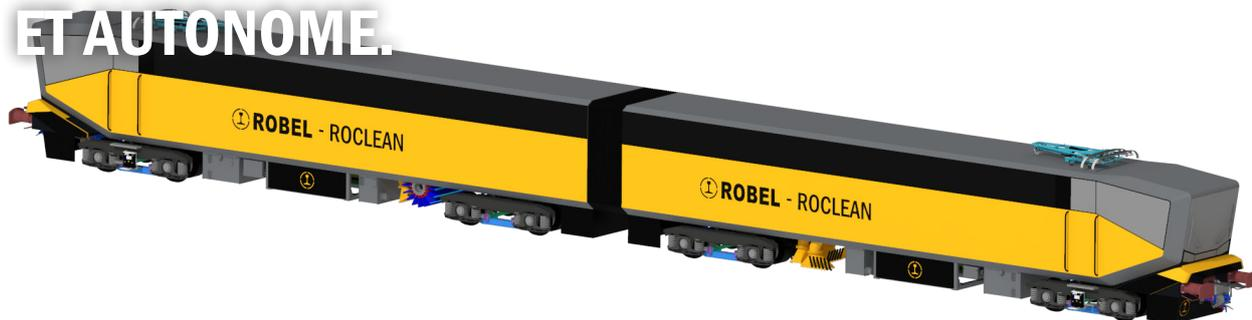
Système de nettoyage des voie sous forme de conteneur à monter sur des wagons plats avec une alimentation en énergie autonome en énergie.
