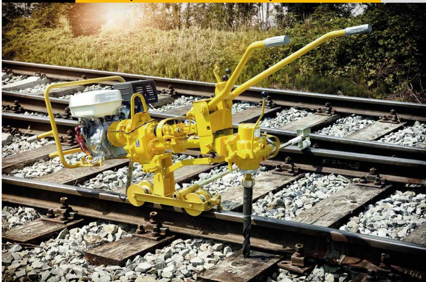
**Для всех винтовых и сверлильных работ при строительстве железнодорожного пути. Особенно подходит для установки дюбелей.**
