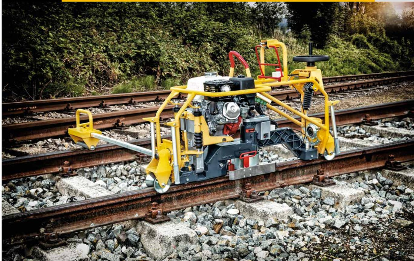
**Для высокоточного шлифования головки рельса после сварочных работ и безупречного восстановления профиля**
