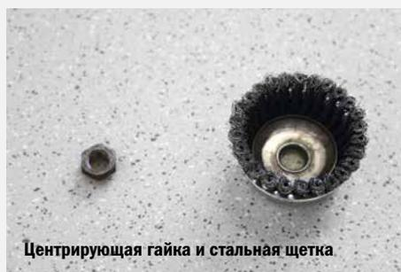
Центрирующая гайка и стальная щетка
