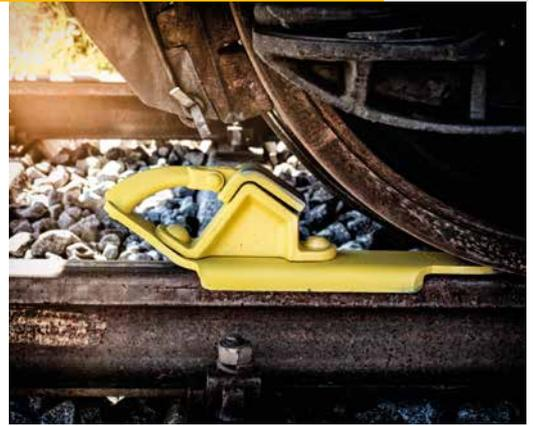
**RORERAIL****Oreille de cochon****59.12****Pour mettre en voie des véhicules ferroviaires**
