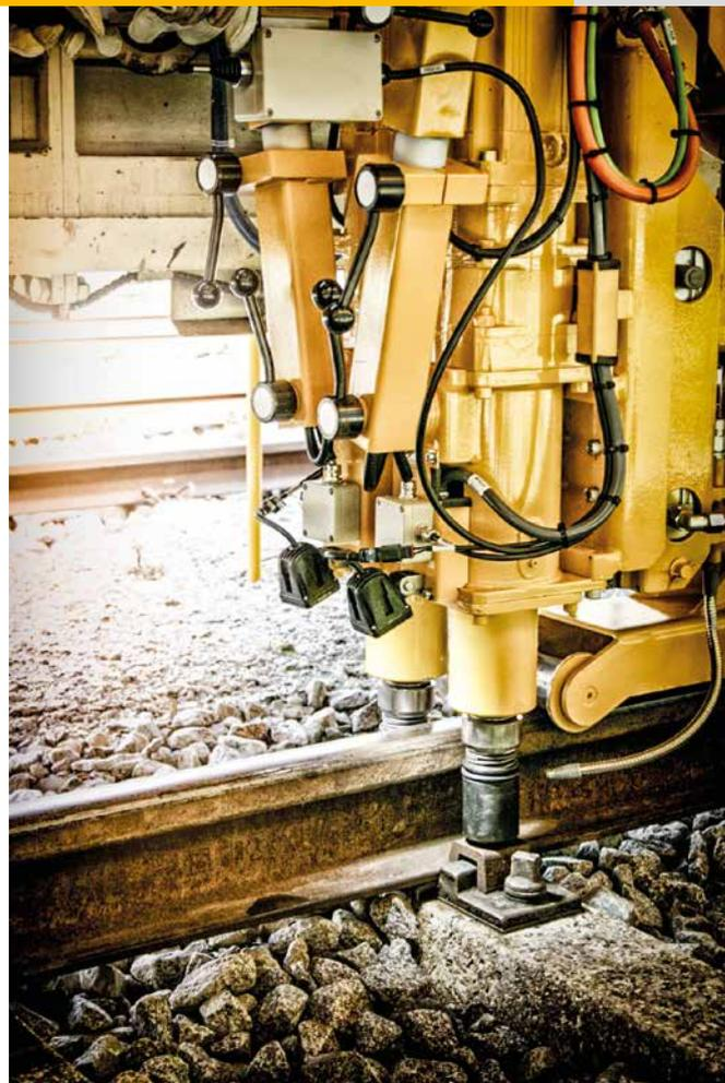
**Pour le serrage et le desserrage synchrone de tous les travaux de vissage en construction ferroviaire au sein de l'unité de maintenance mobile de ROBEL.**
