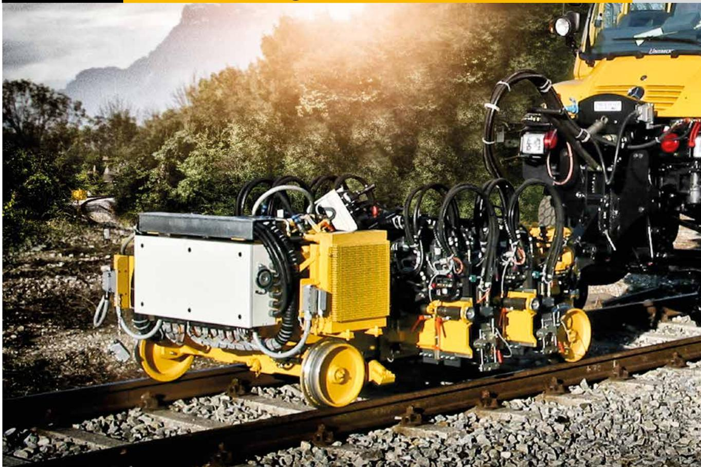
**Pour le serrage ou le desserrage simultané entièrement automatique de jusqu'à 8 attaches de rails en une seule opération ainsi que pour le vissage synchrone au niveau des dispositifs de serrage.**
