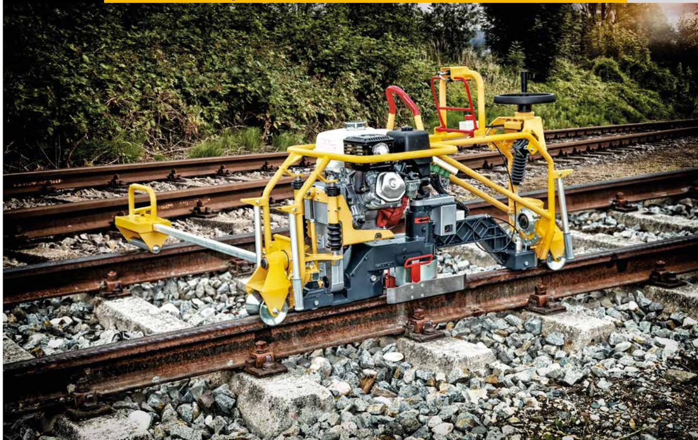
**Pour façonner le champignon du rail après les travaux de soudage permettant la remise en état d'un profil impeccable**
