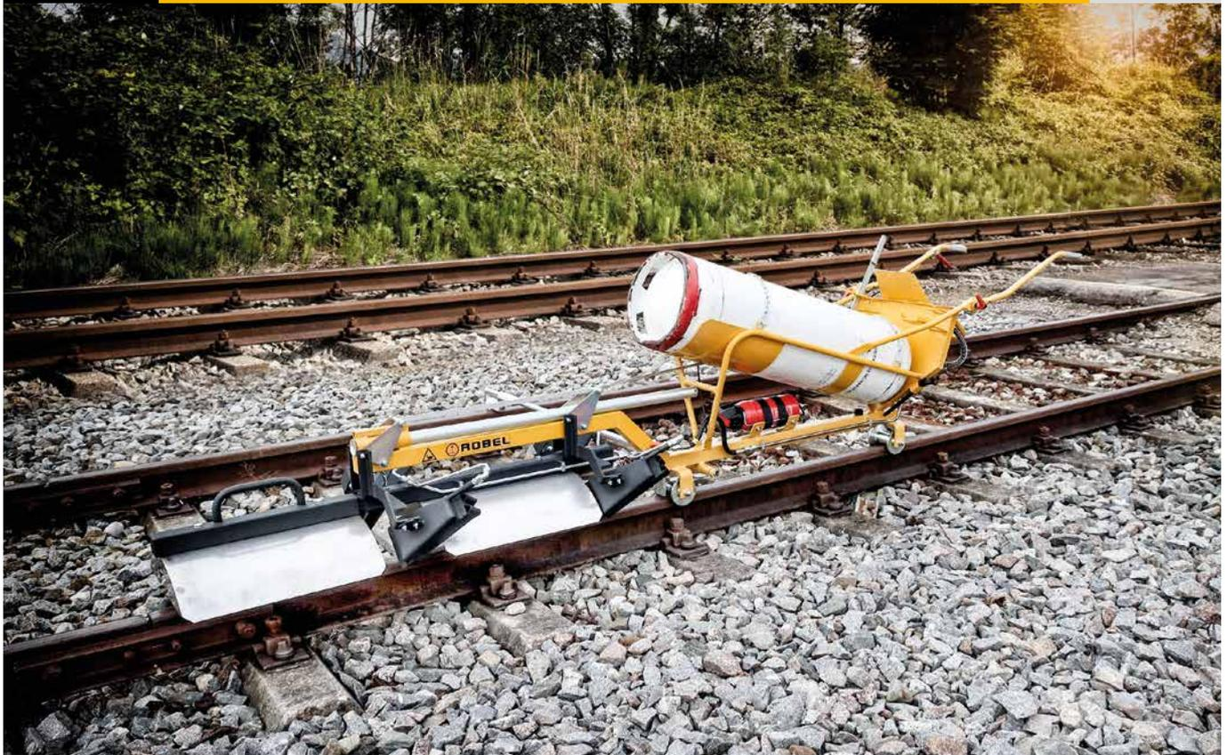
Este equipo permite calentar el carril a la temperatura teórica requerida para la compensación longitudinal en el marco de las neutralizaciones de carril previas a las soldaduras por fusión.
