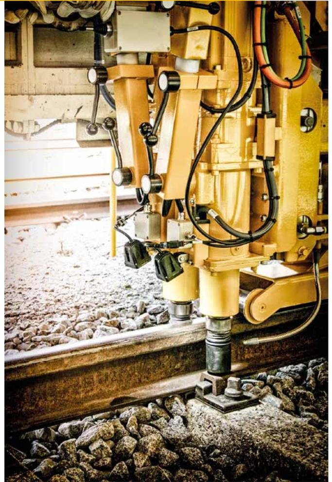
Para realizar sincronizadamente todas las operaciones de apriete o aflojamiento de tornillos necesarias en una obra ferroviaria desde la unidad móvil de mantenimiento ROBEL.
