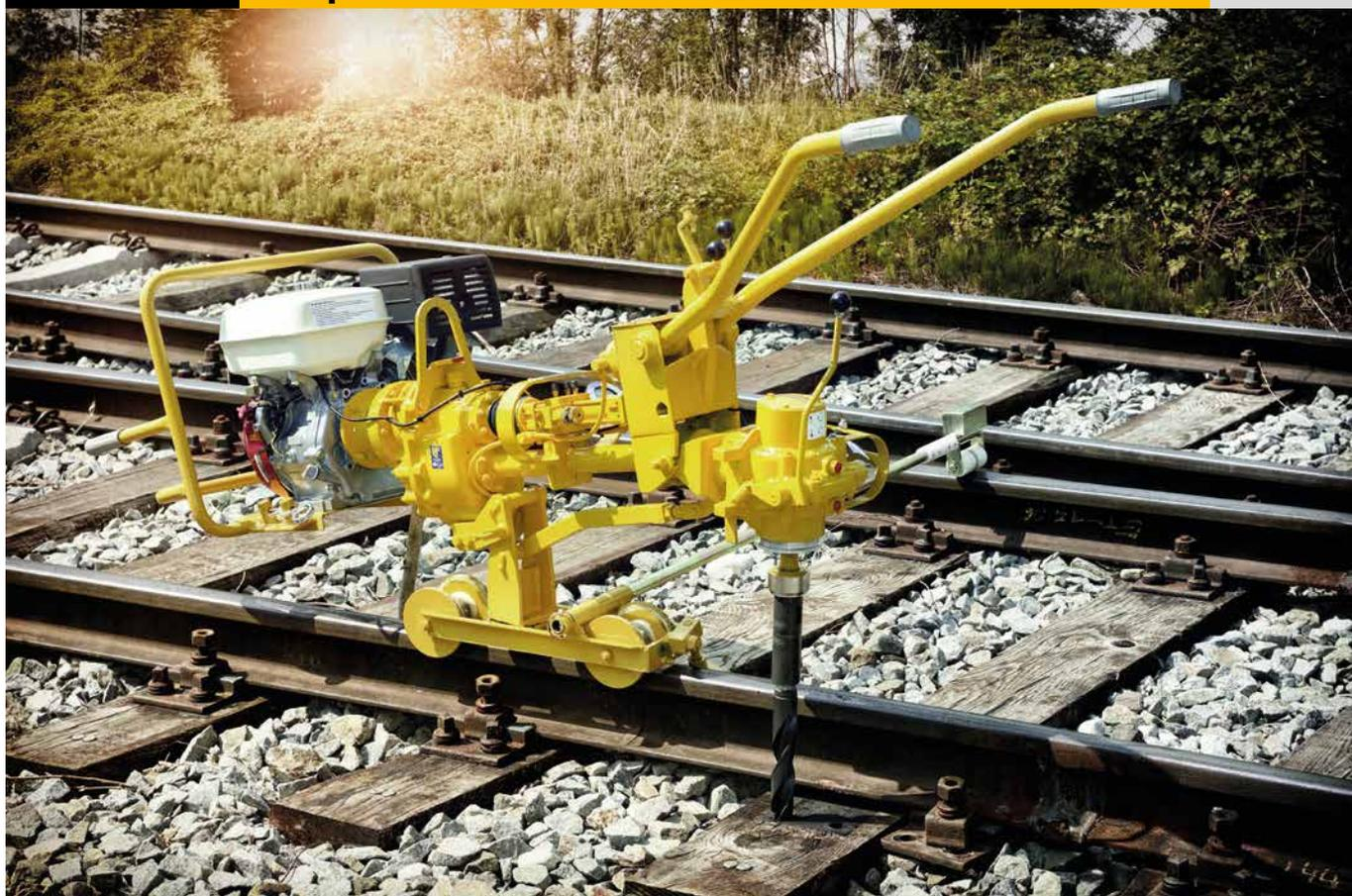
**Para todo tipo de trabajos de atornillado y taladrado en la construcción de vías. Especialmente indicada para el saneamiento de tarugos.**
