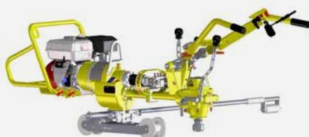
b. Bastidor de rodadura transversal de cuatro ruedas
