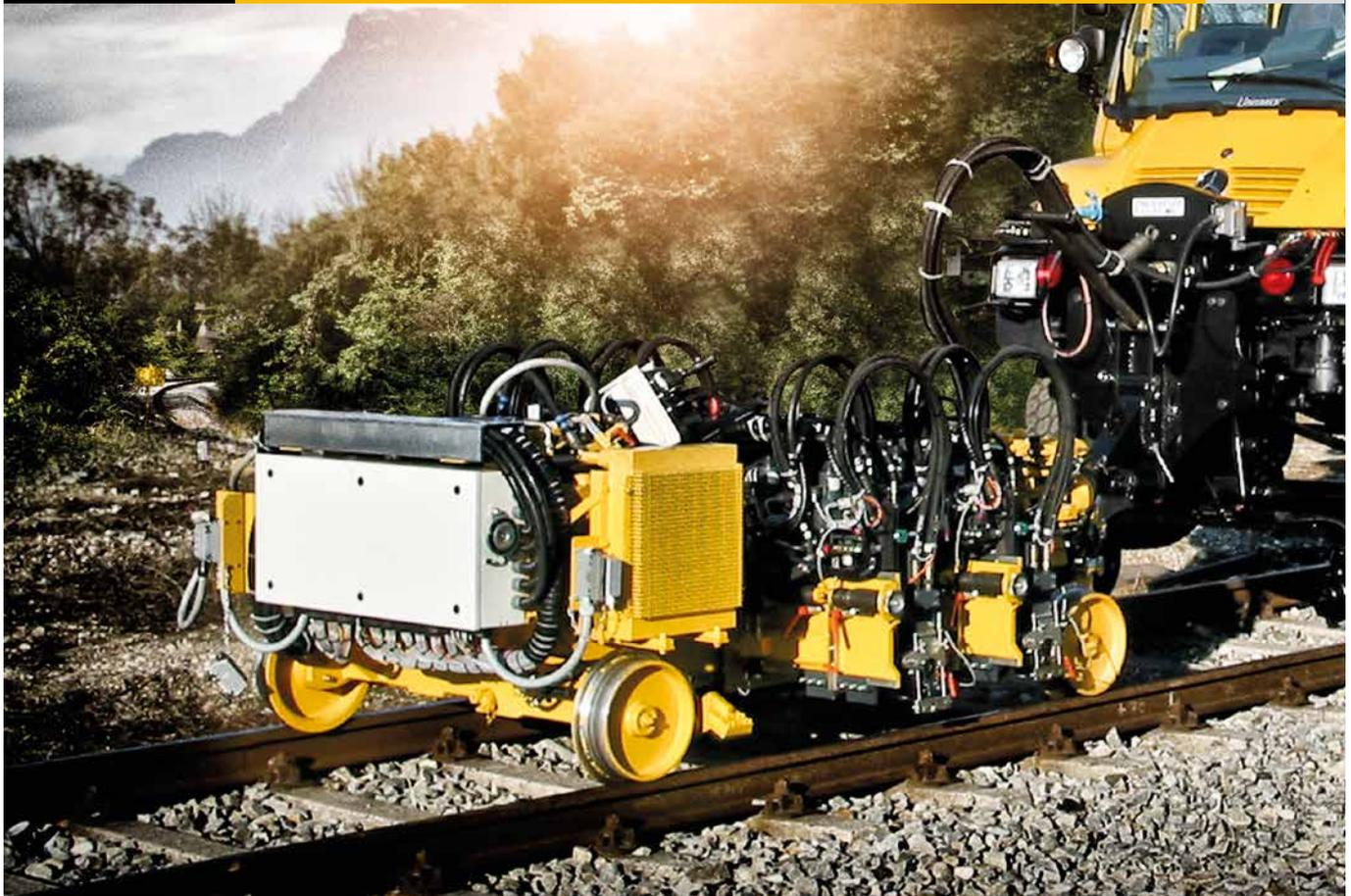
**Para atornillar/desatornillar simultáneamente y totalmente automatizado hasta ocho sujeciones de carril en un solo ciclo de trabajo y para atornillar de forma sincrónica clips elásticos.**
