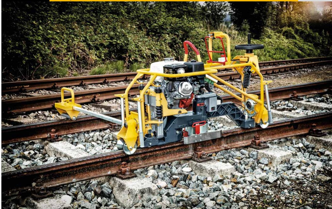
Para el esmerilado conforme a su forma de la cabeza del carril después de efectuados los trabajos de soldadura con recuperación perfecta del perfil
