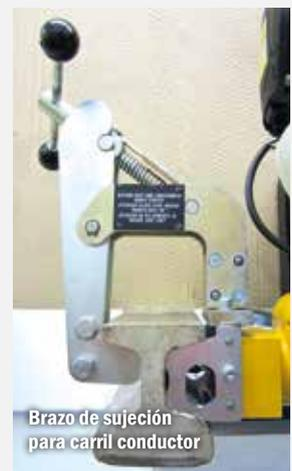
Brazo de sujeción para carril conductor
