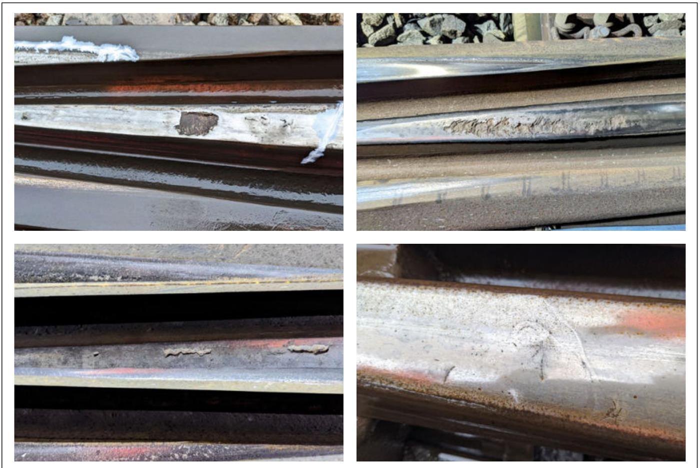
**Abb. 4:** Weichenschäden, die automatisiert behoben werden können: Abnutzung an Flügelschiene und Weichenherz sowie Ausbruch an Herzstückspitze auf bereits repariertem Abschnitt | Ausbrüche an Herzstückspitze aufgrund zu niedriger Flügelschiene / einseitiger Belastung | Risse und Ausbrüche an Flügelschiene und Herzstückspitze | wasserstoffinduzierter Riss durch fehlerhaftes Vorwärmen
