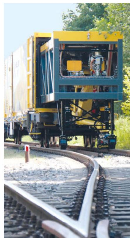
Abb. 1: Die Weicheninstandhaltung ist eines der ersten Anwendungsgebiete der Automatisierungstechnik am Gleis.
